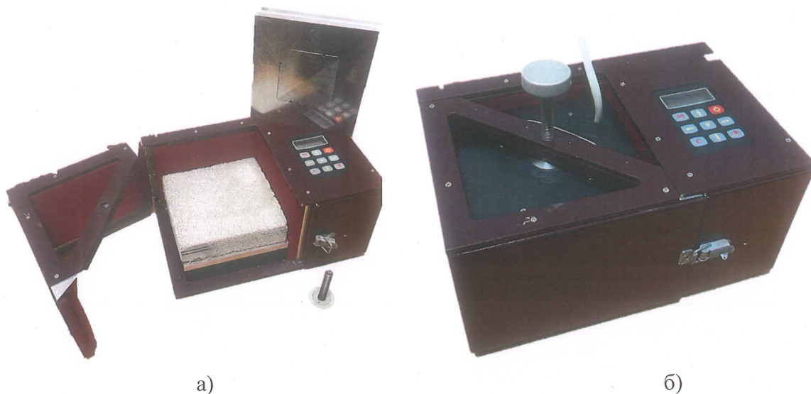
Рисунок 1. Определение коэффициента теплопроводности: а) прибор с образцом; б) прибор в собранном виде
